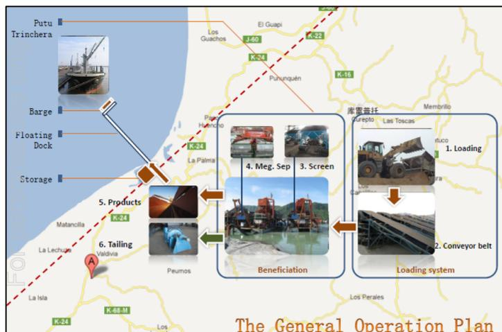
Este tipo de minería, lo que hace es mediante unos rodillos magnéticos sacar la arena, para luego separar la arena y el concentrado de hierro. Es necesario destacar que en las dunas se llegó a estimar que existía un 75% de hierro, es decir, de un kilo de arena, hay 750 gr de hierro.
