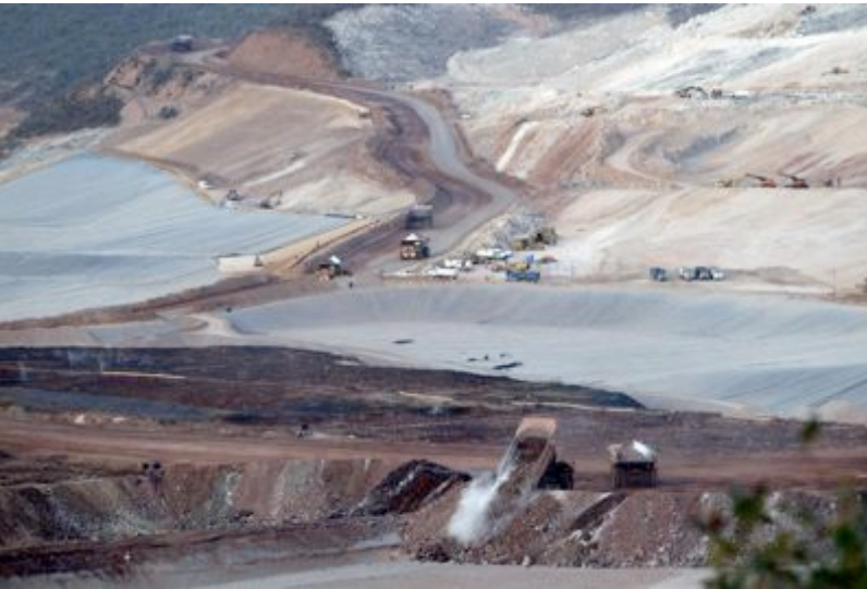
Colocación de Material y Riego con Cianuro de Sodio en el Patio de Lixiviados
