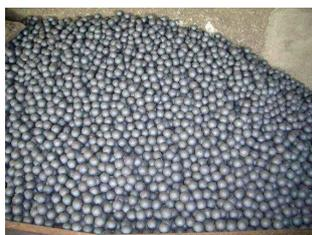
Figura 4-4: Bolas de acero utilizadas en la molienda
