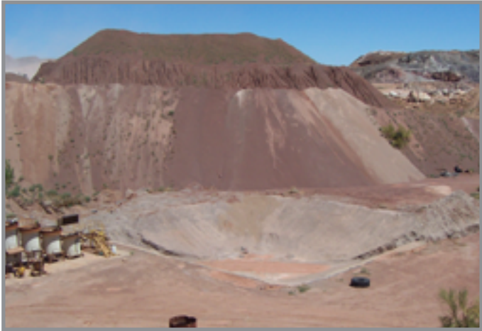
Lixiviación en pilas, mina de oro Bighorn, California, EEUU FOTO: Bender Environmental Consulting
