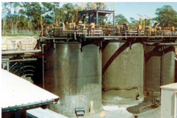
Figura 10 Ejemplo de tanques de lixiviación (foto: John Neal, Mintek).
