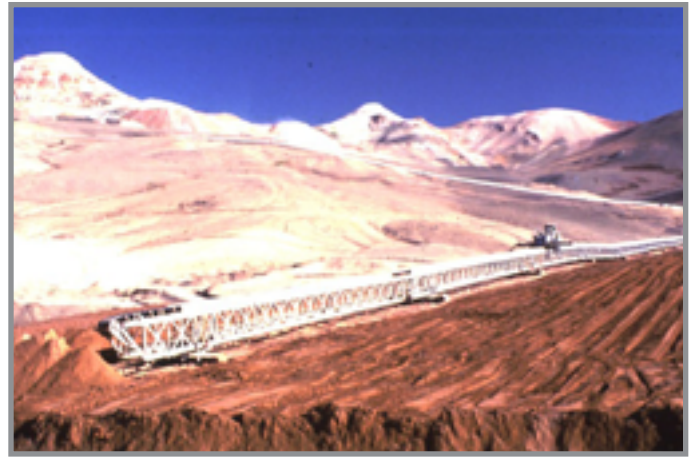
Método de disposición de relaves secos. Mina La Coipa, Chile
