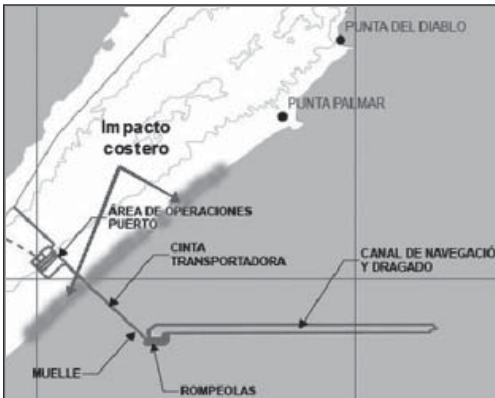
Diagrama del puerto proyectado por Aratirí (sombreada la zona de alteración de la costa a ambos lados del muelle).
