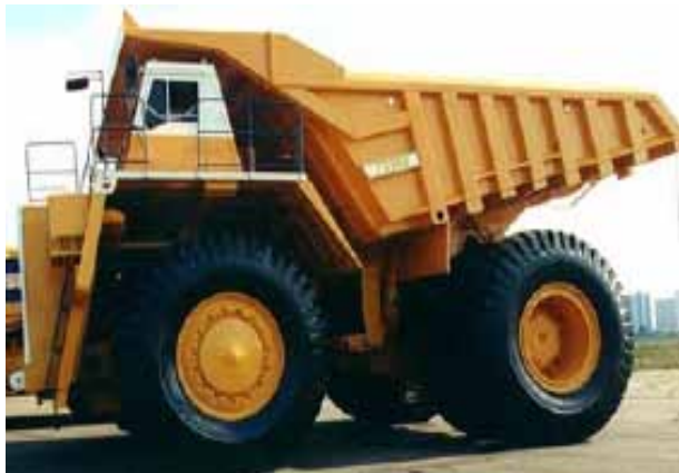
Gigante camión: 13,36 m, largo: 7,78 m, altura: 6,65 m ancho
